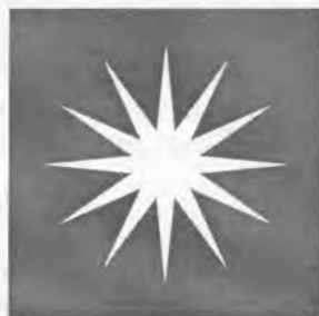
Obr. 19.2 Ilustrace Kirchhoffova zákona. Nahoře: keramická deska s černě nakresleným vzorem. Dole: deska zahřívá na vysokou teplotu se ve tmě jeví tmavě oproti vzoru, který má větší emisivitu
