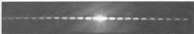
Obr. 8.21 Difrakce světla na vlasu; střed obrazce je překryt přímo procházejícím laserovým svazkem helium-neonového laseru na vlnové délce 594 nm
