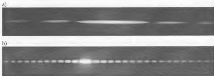
Obr. 8.3 Difrakční obrazec při Fraunhoferově difrakci na štěrbinách šířky a) b=20\mu\text{m} a b) b=100\mu\text{m} , štěrbiny byly osvětleny kolimovaným svazkem helium-neonového laseru o vlnové délce 594\text{ nm}
