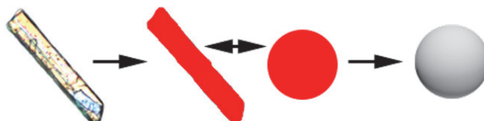
Obr. 75. Postup aproximace částice na objem ekvivalentní koule
