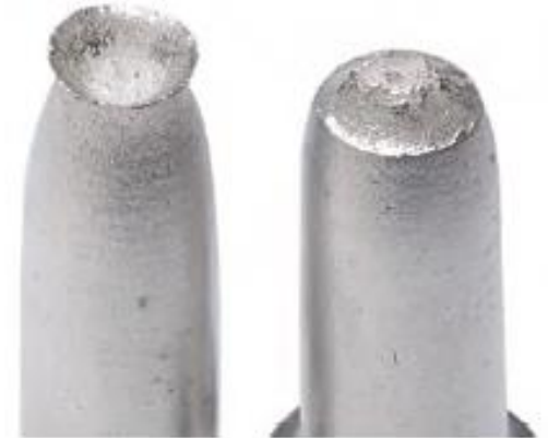
tvárný lom vzorku hliníku
