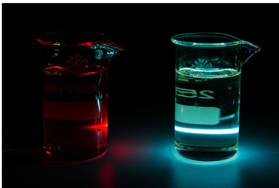
Obr. 66: Porovnání fluorescence olivového (vlevo) a slunečnicového (vpravo) oleje při použití modrofialového laserového ukazovátka (405 nm).
