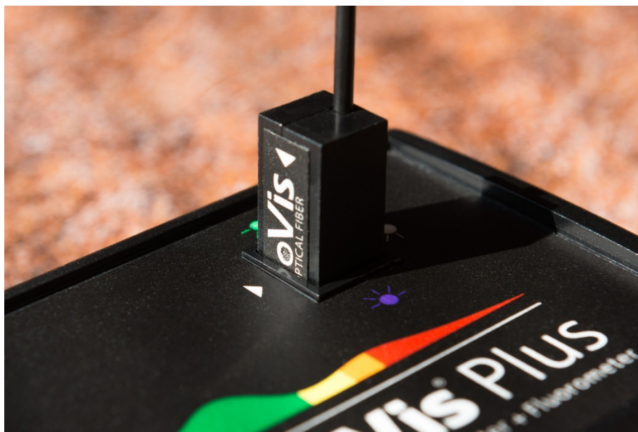
Obr. 38: Správná orientace spodního dílu optického vlákna Vernier SpectroVis Optical Fiber při zasouvání do držáku kyvet ve spektrometru.
