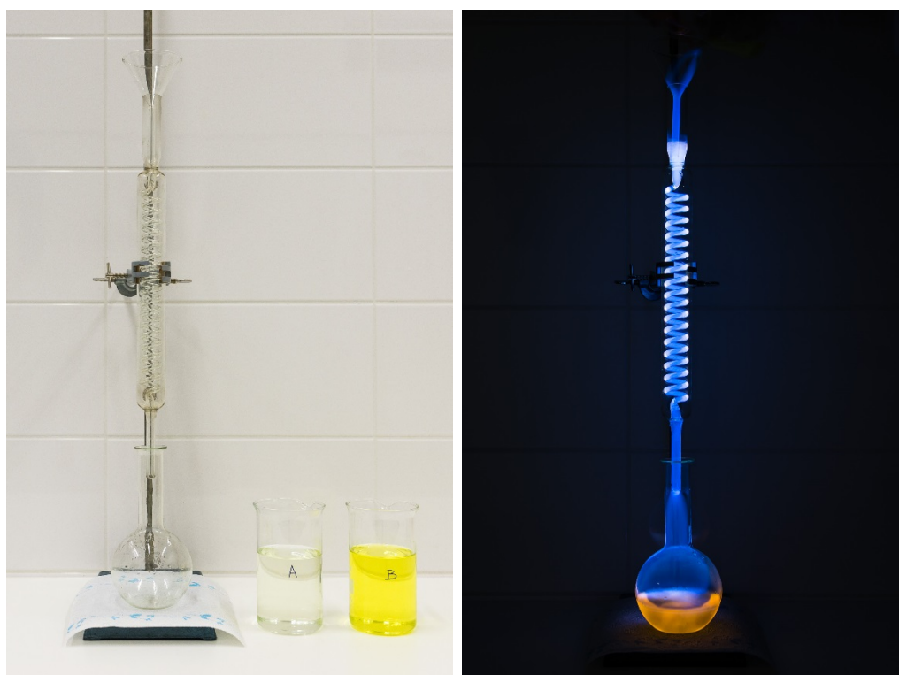
Obr. 98: Připravená aparatura na světle (vlevo) a průběh chemiluminiscenční reakce luminolu s přidavkem eosinu Y (vpravo).
