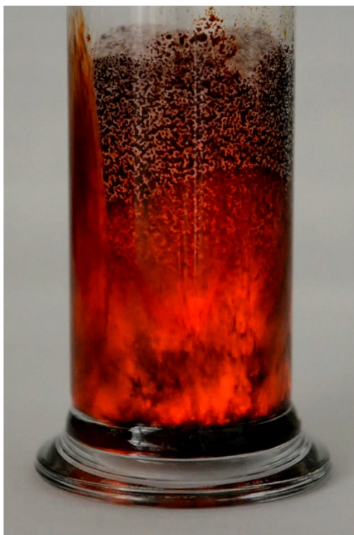
Obr. 103: Prudká chemiluminiscenční reakce po přilítí malého množství \text{H}_2\text{O}_2 do válce s reakční směsí.
