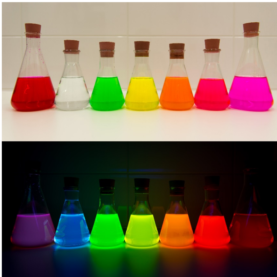
Obr. 44: Porovnání luminiscenčních roztoků na světle a pod UV zářivkou (zleva: směs rhodaminu a chininsulfát dihydrátu, chininsulfát dihydrát, výluh ze zeleného zvýrazňovače, fluorescein, eosin Y, rhodamin B v ethanolu, rhodamin B v 0,1M-H 2 SO 4 ).
