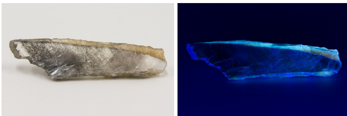
Obr. 50: Sádrovec z Koberžic u Opavy. V tomto případě luminiscenci způsobují inkluze vyšších uhlovodíků.
